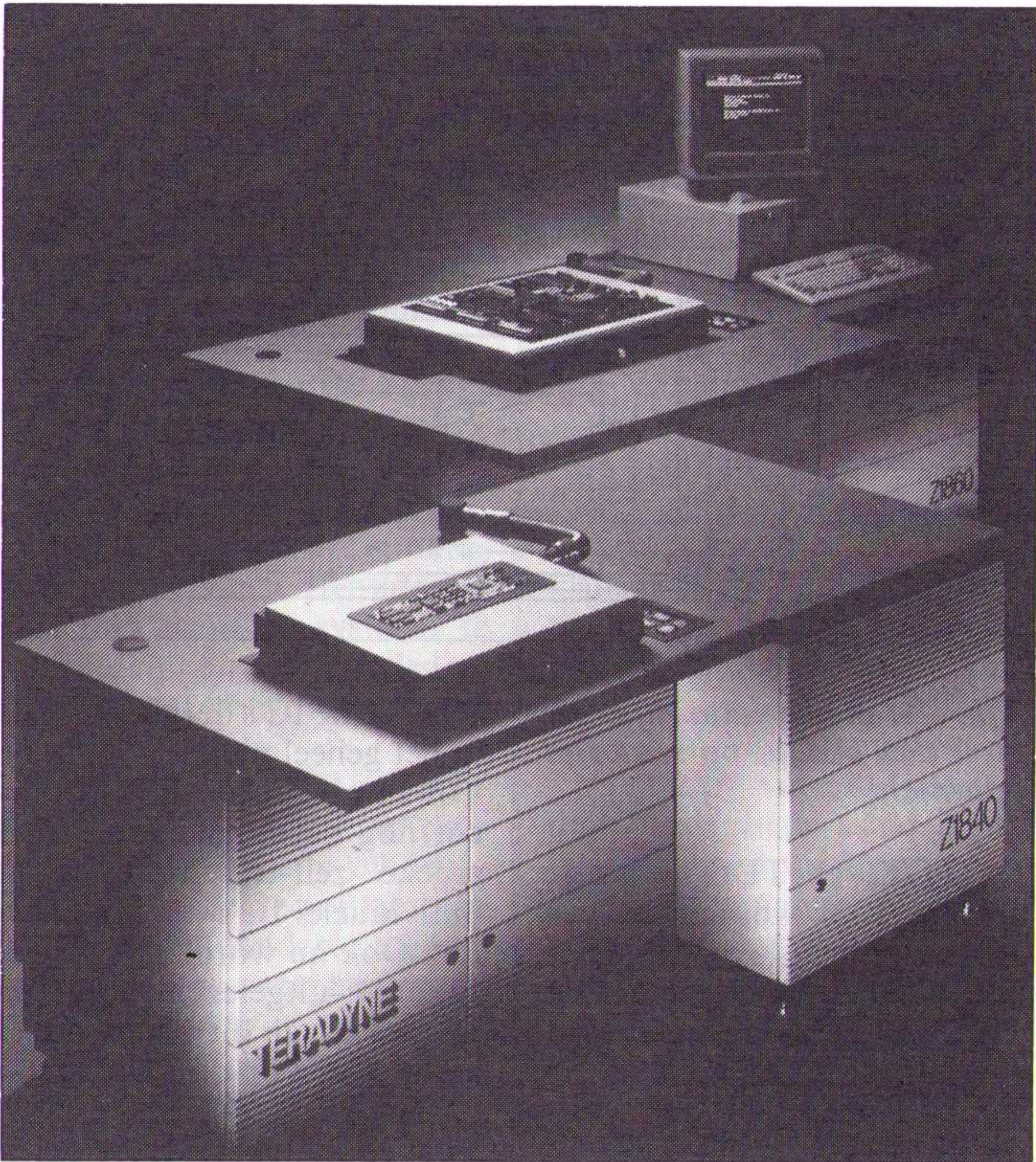
Afb. 2 Geassembleerde printen worden via dergelijke testautomaten met naaldenbedden getest.
